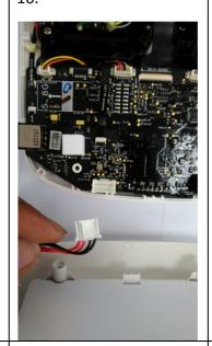
將與上蓋連接的電源線 插頭拔開後就可以將背 蓋放置一旁
