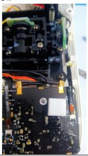
線材排好後將插頭插入 即可 左邊天線插右孔
