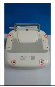
將背面上 4 個塑膠拔除. 可以看到 4 個孔固定上 下蓋螺絲.
