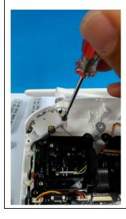
將遙控器左上角的控制 鈕的螺絲卸下
