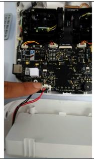
背蓋組裝回去時.背蓋的電源線要先接上前蓋的插槽
