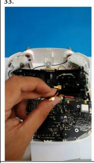
線材在依機構的方向去 繞.以不影響搖桿操作 為主就可以
