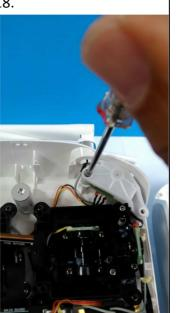
將遙控器右上角的控制 鈕的螺絲卸下
