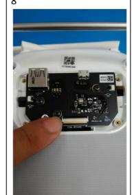
必須將中間這條軟排線 拆下才可以拆開上下蓋
